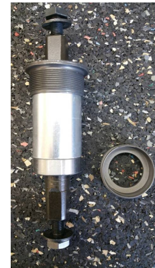
Cartouche de Boitier de pédalier : roulements intégrés, graissés à vie, joint d'étanchéité. Corps métal ou plastique
